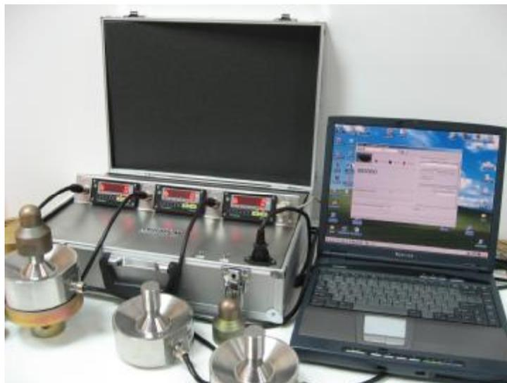
Рисунок 1 – Внешний вид системы модификации "Центран"-15-3 в комплекте с БОИ и с внешним регистрирующим устройством.
