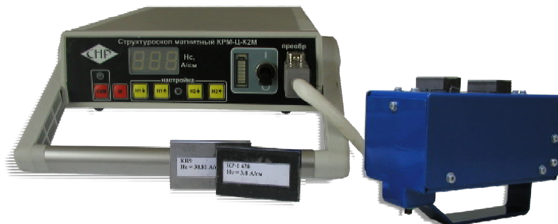
Рис. 1 Структуроскоп магнитный КРМ-Ц-К2М
