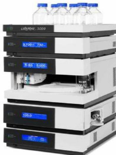
Рис.1 Фотография общего вида хроматографа жидкостного UltiMate 3000.
