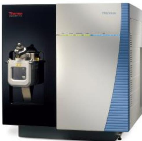
Рис. 4 Фотография общего вида масс-спектрометрического детектора TSQ Endura.
