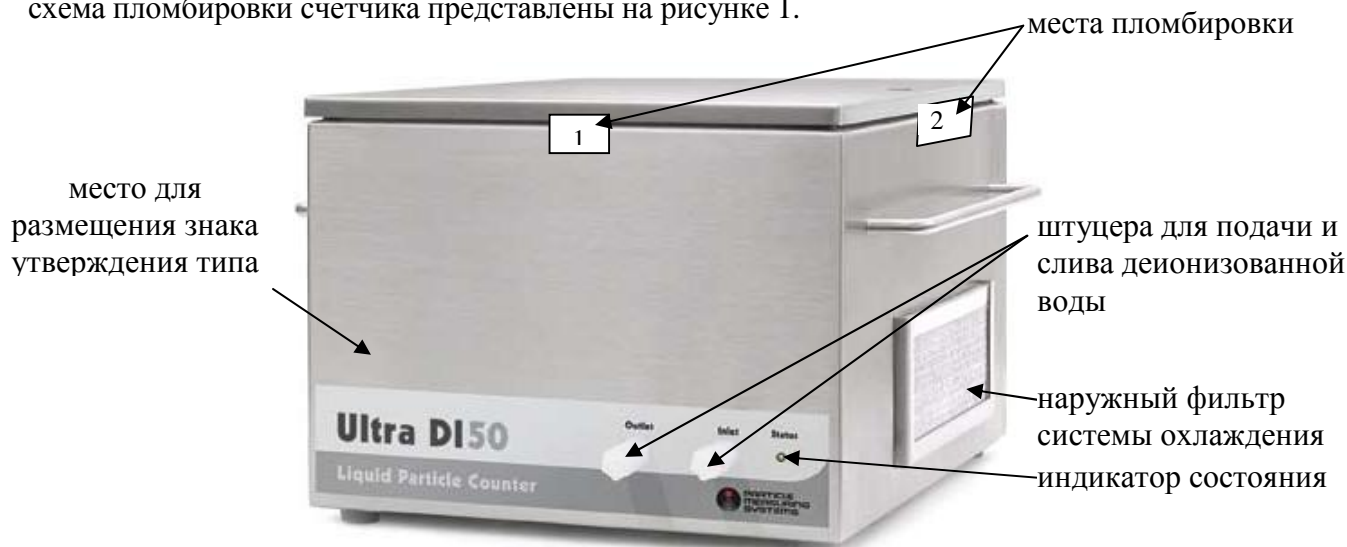
Рисунок 1 – Внешний вид счетчика, обозначение места для размещения знака утверждения типа и схема пломбировки счетчика
