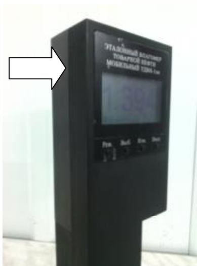
Рисунок 2 - Место пломбирования влагомеров эталонных товарной нефти мобильных УДВН-1эм
