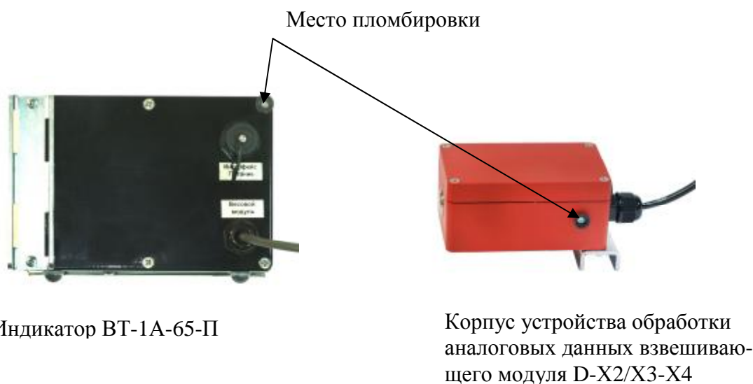
Рисунок 2 - Место пломбировки от несанкционированного доступа
