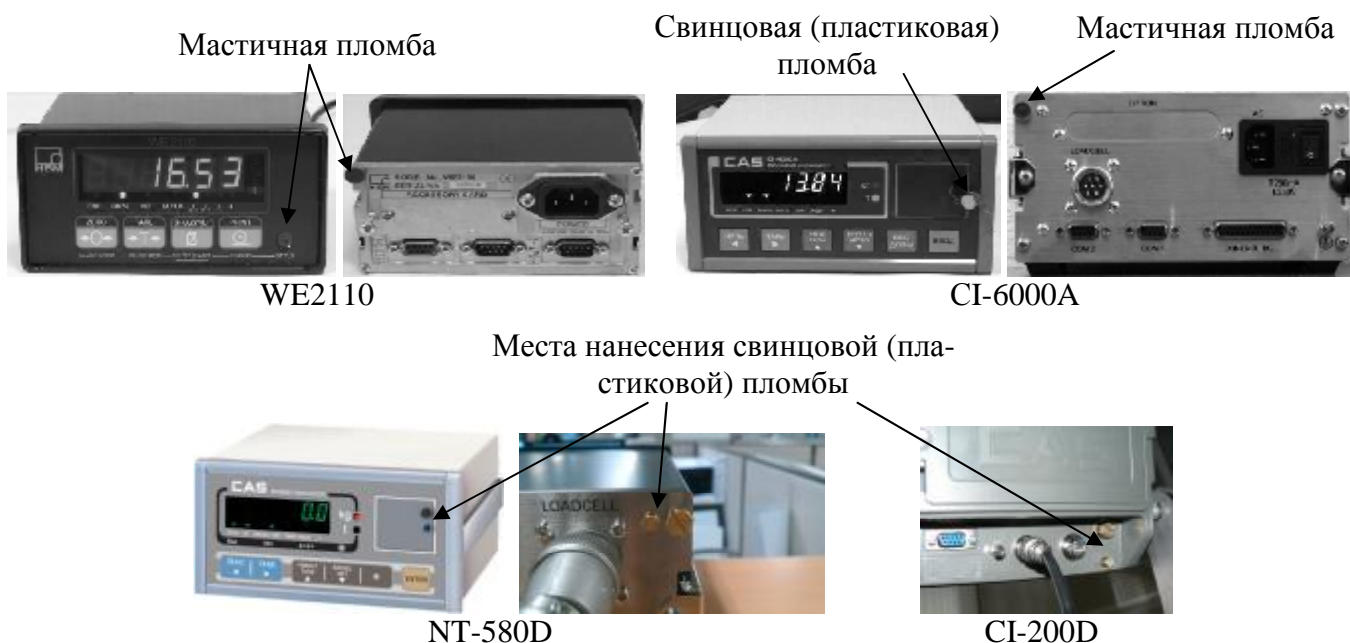
Рисунок 5 – Схема пломбировки приборов весоизмерительных
