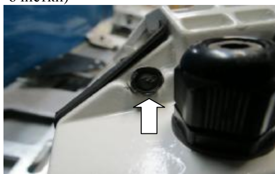
Рисунок 4 – схема пломбировки видео модуля
