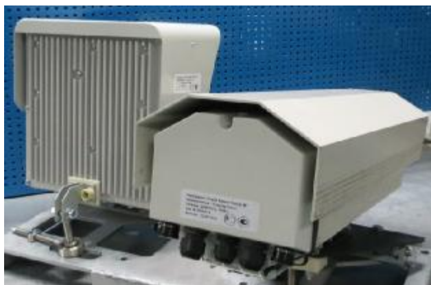
Рисунок 1 - общий вид комплекса с модулем радиолокационного измерения скорости
