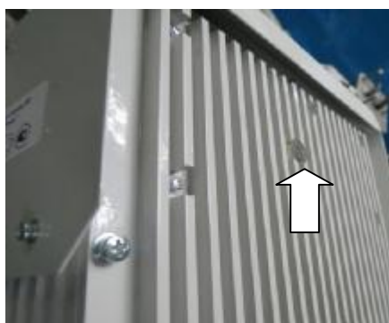
Рисунок 3 – схема пломбировки модуля радиолокационного измерения скорости
