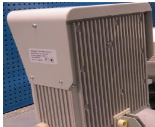
Рисунок 6 – Место нанесения знака утверждения типа на модуль радиолокационного измерения скорости
