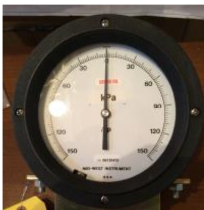
Рисунок 1. Фотография манометра дифференциального модель 109UF-10-(FTUY)O.
