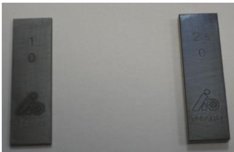
Рисунок 1 – Общий вид мер длины концевых плоскопараллельных
