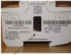
Клеймо поверителя наносится на боковую поверхность прибора в виде наклейки и дублируется в паспорте в разделе «свидетельство о поверке»
