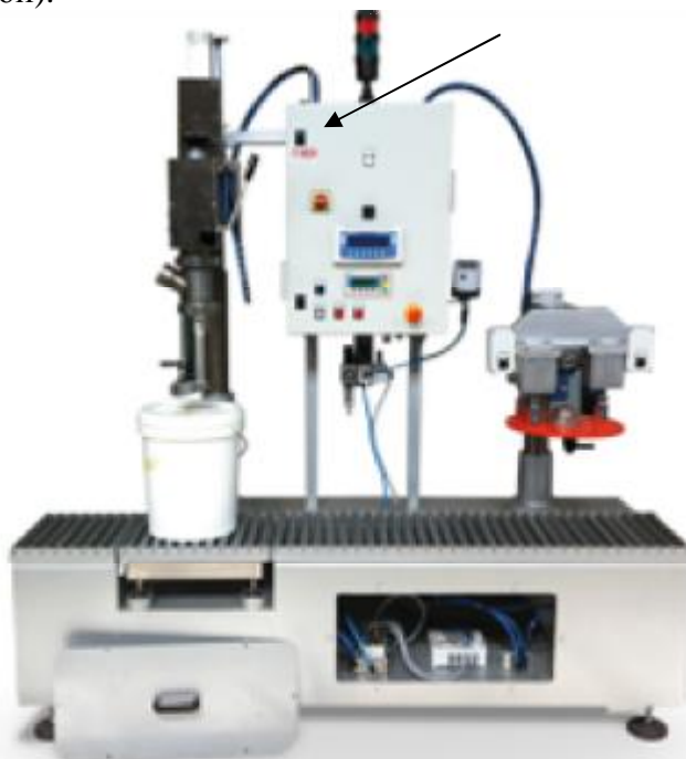
Рисунок 1 – Внешний вид полуавтоматического дозирующего устройства со встроенными весами специальными DSP 60.
