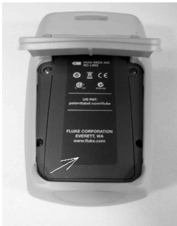
Рисунок 2 - Вид калибраторов с обратной стороны (стрелкой показано место нанесения знака утверждения типа)
