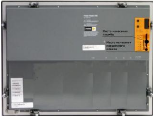
Место установки пломбы и поверительного клейма на контроллер.
