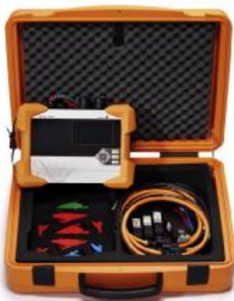
Рис.2 Внешний вид и места пломбирования PQ-Vox 200.
