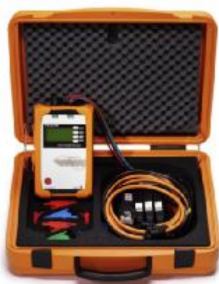
Рис.1 Внешний вид и места пломбирования PQ-Vox 100.
