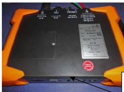
Рис.2 Внешний вид и места пломбирования PQ-Vox 200.
