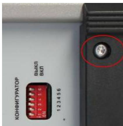
Рисунок 3 – Схема пломбировки от несанкционированного доступа (выделено).
