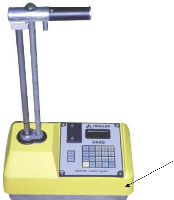
Рисунок 1. Внешний вид влагоплотномера TROXLER. Стрелкой обозначено место нанесения знака поверки.
