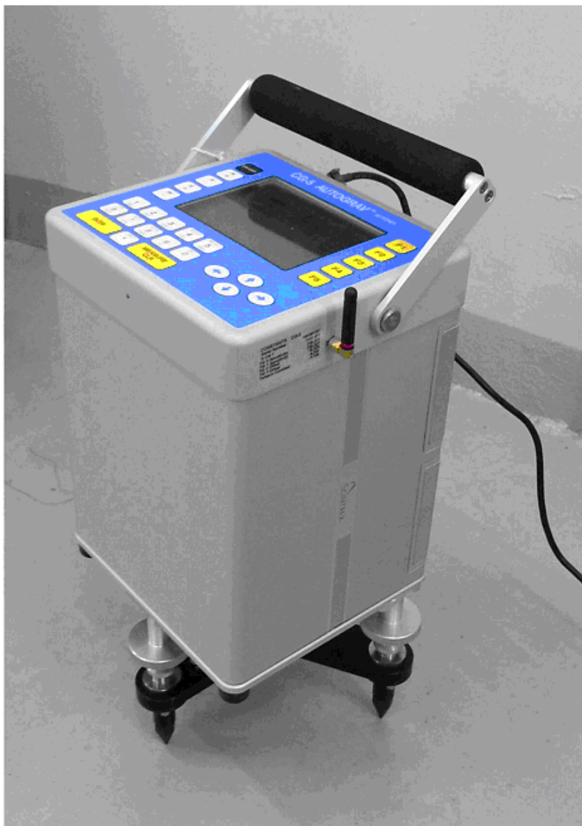
Рисунок 1. Внешний вид гравиметра CG-5 Autograv
