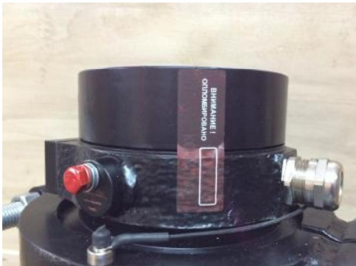
Рисунок 2 – Место пломбирования счетчиков жидкости ДЕБИТ
