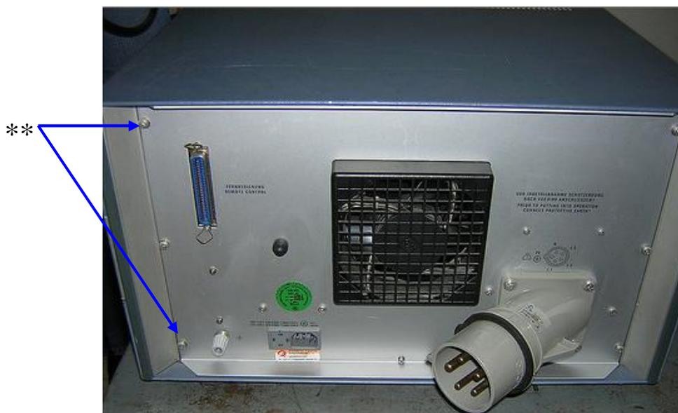
\*\* - места пломбировки от несанкционированного доступа
