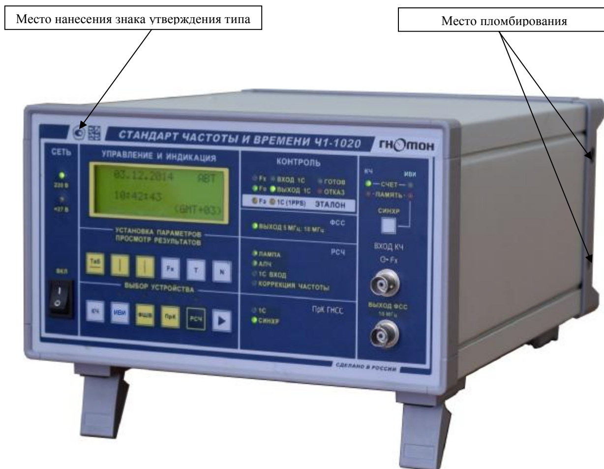
Рисунок 1 - Общий вид прибора и место пломбировки от несанкционированного доступа
