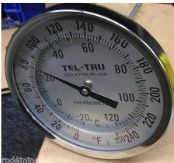
Рис.1 Термометр биметаллический исполнения GT500-6
