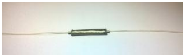
а) Первичные преобразователи тензодатчиков ВОТД с подложкой (Тип Б)
