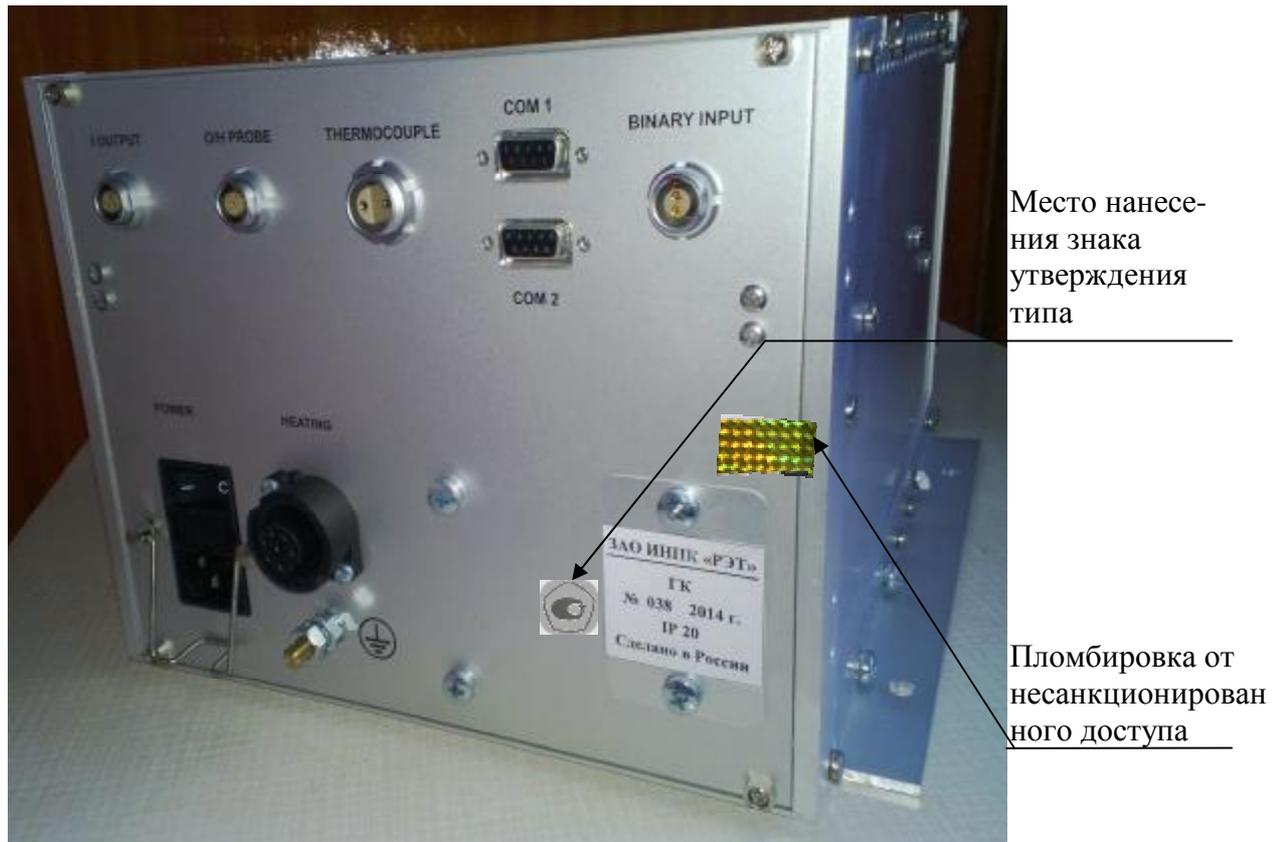
Рисунок 2 – Внешний вид измерительного блока газоанализатора. Вид сзади
