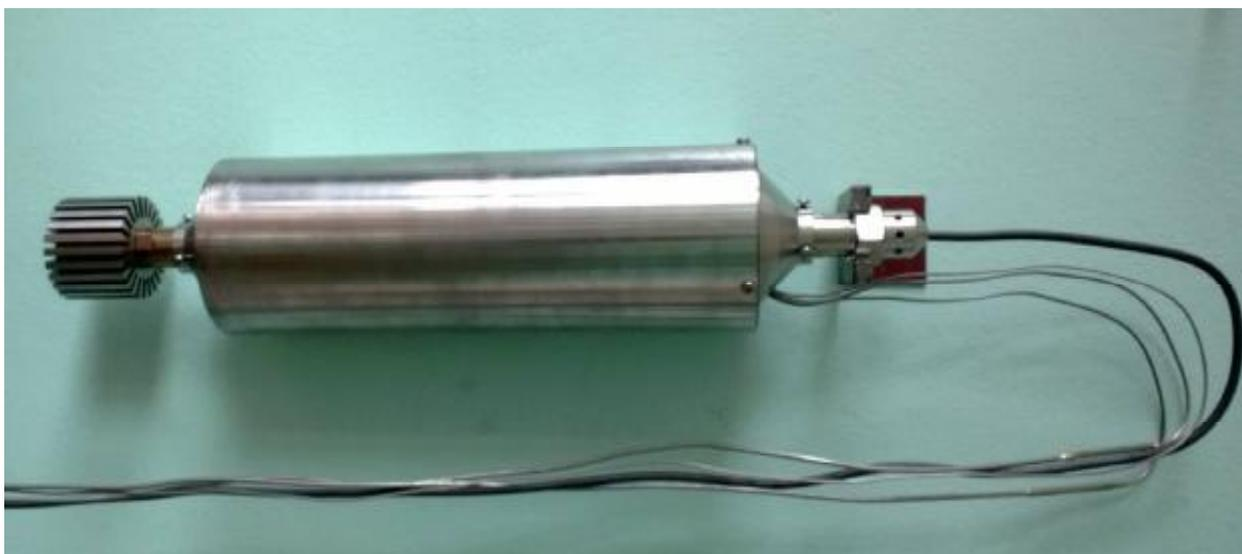
Рисунок 1 – Внешний вид датчика газоанализатора
