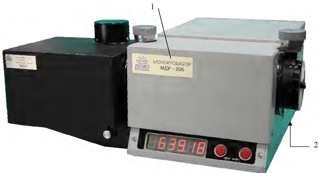
Рисунок 3 - Общий вид, места пломбирования и маркировки монохроматора спектральной установки
