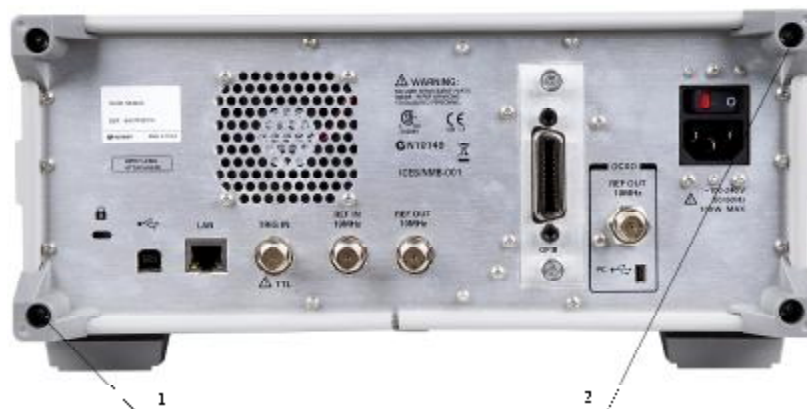
Рисунок 2 – Схема пломбировки анализаторов от несанкционированного доступа, где 1; 2 – места для нанесения оттисков клейм.
