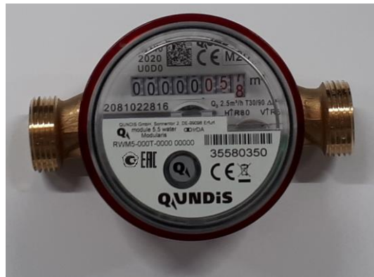
Рисунок 2 – Общий вид счетчика горячей воды Q water с механическим отсчетным устройством
