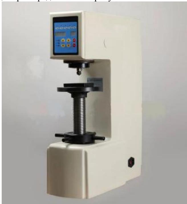
Рисунок 1. Общий вид твердомеров ИТБ-АМ.
