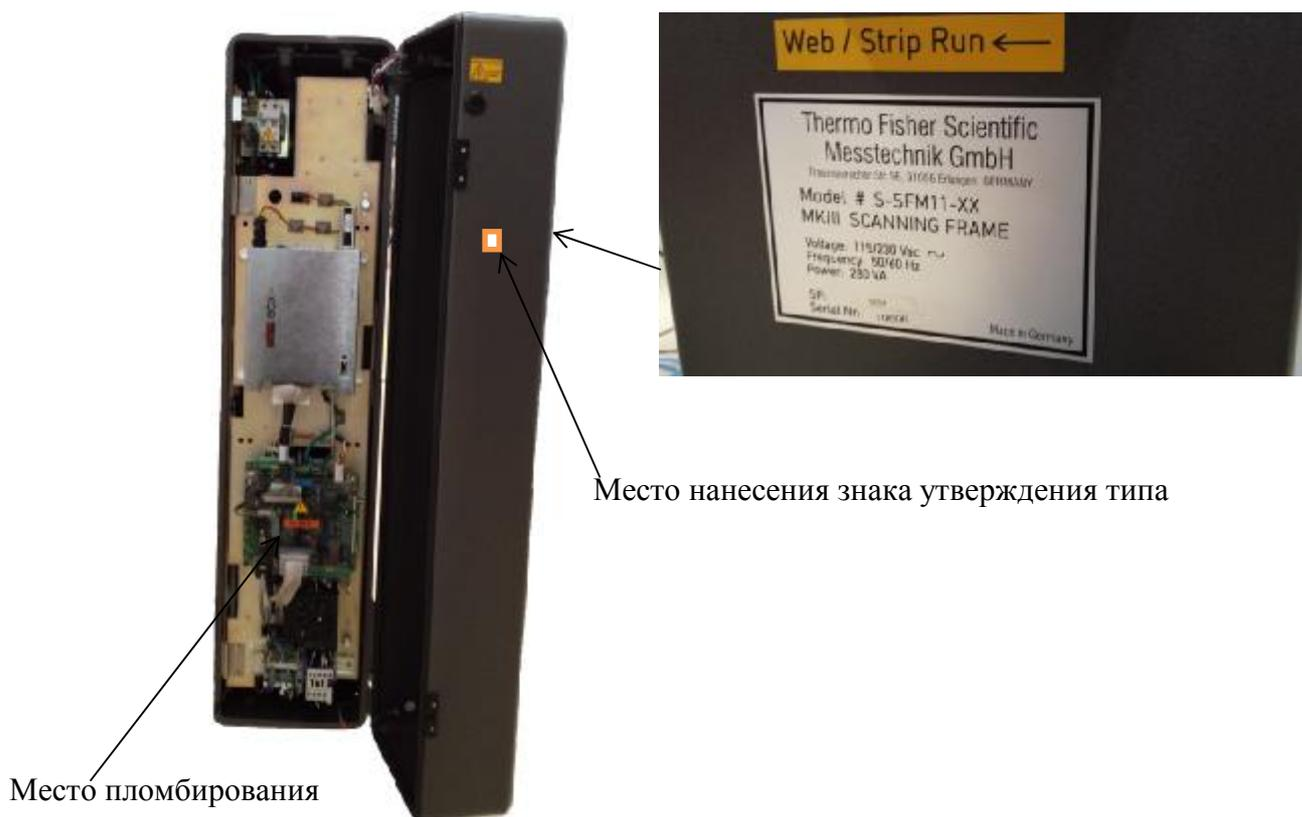
Рисунок 3 – Система измерения толщины пленки инфракрасным методом PROSIS (вид с боку), обозначение мест нанесения знака утверждения типа, пломбирования и маркировки.
