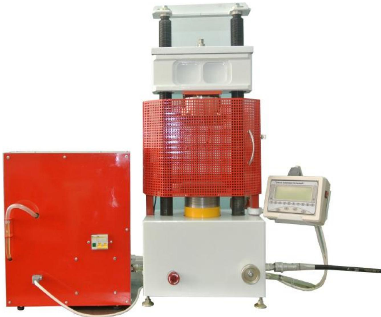
Рисунок 1 - Внешний вид пресса гидравлического измерительного ПГИ-500-02
