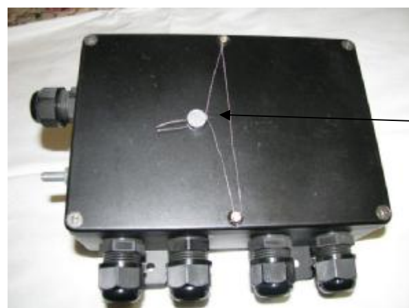
Рисунок 3 - Схема установки пломбы или клейма на индикаторы и соединительную коробку
