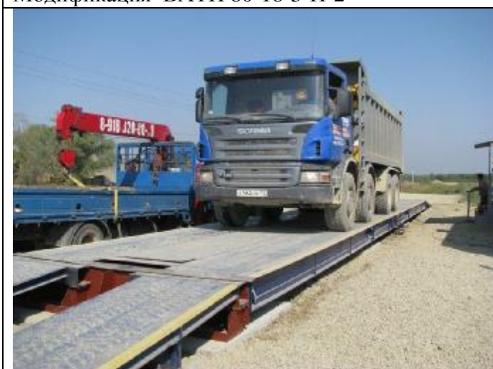
В) Вариант установки на поверхность с опорной рамой и металлическими пандусами – («бесфундаментные» весы) Модификация ВАТП 80-18-3-Н-2-БФ
