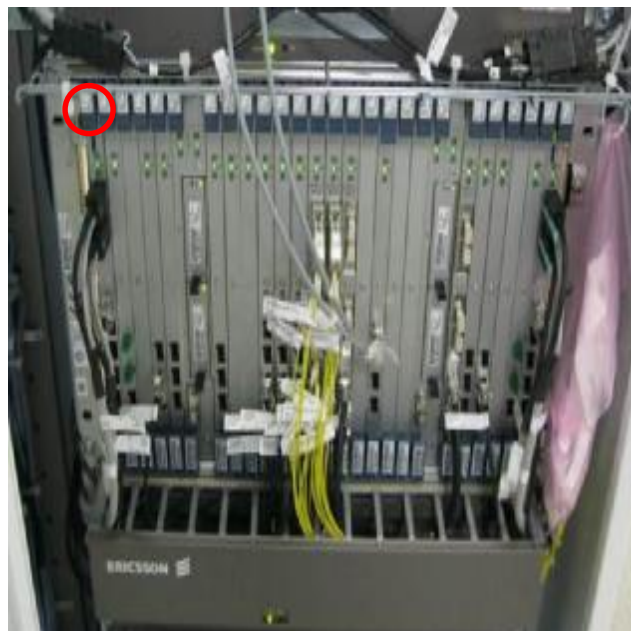
Рисунок 2 - Место блокировки кассетного модуля (выделено)
