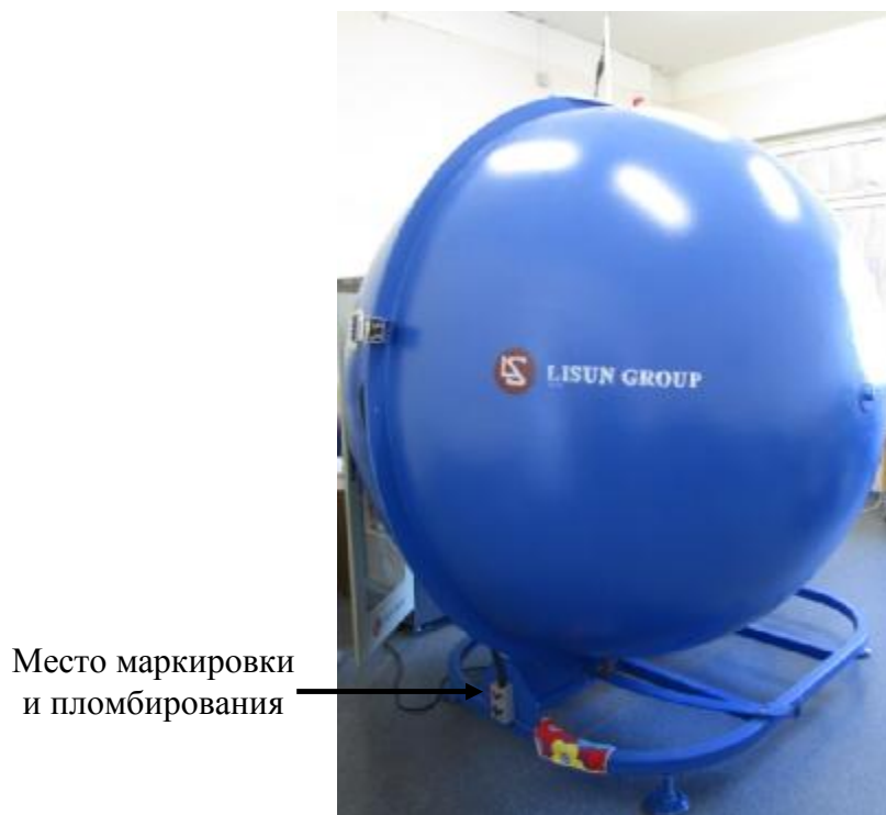
Рисунок 3 – Общий вид фотометрического шара IS с указанием мест маркировки и пломбирования
