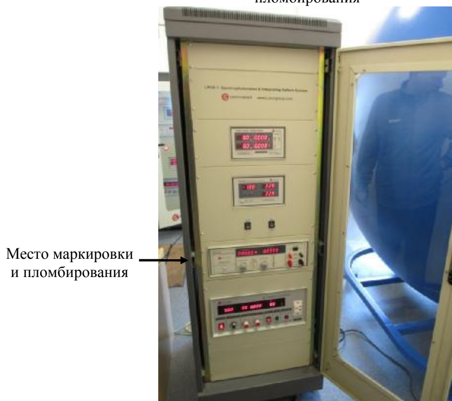
Рисунок 4 – Общий вид стойки управления фотометрического шара IS с указанием мест маркировки и пломбирования
