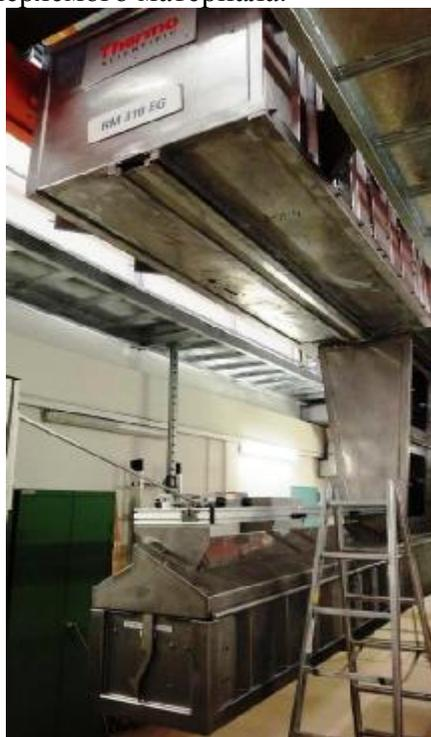
Рисунок 1 - Общий вид системы измерений толщины рентгеновской RM 316 EG.
