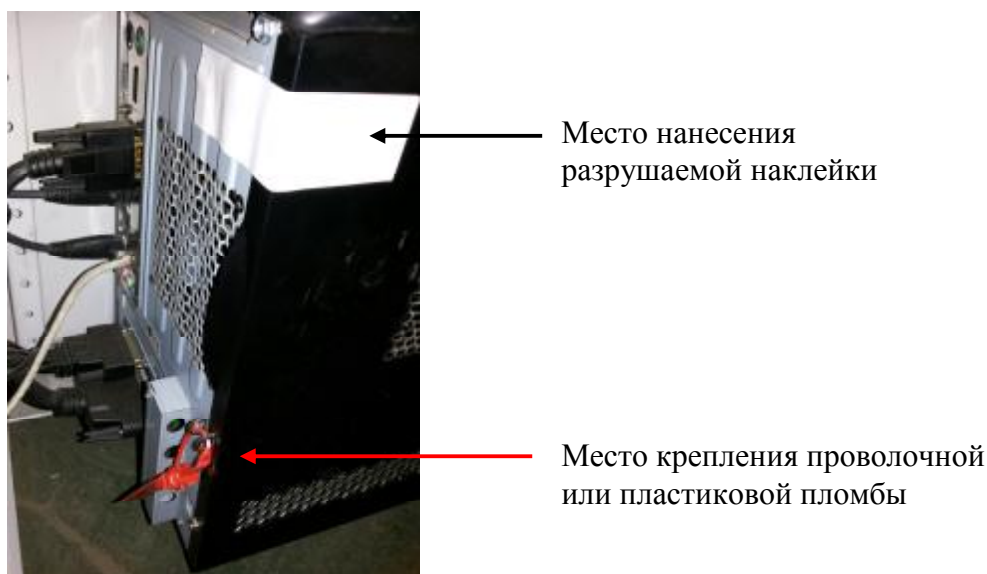
Рисунок 2 — Схема пломбировки АВУ
