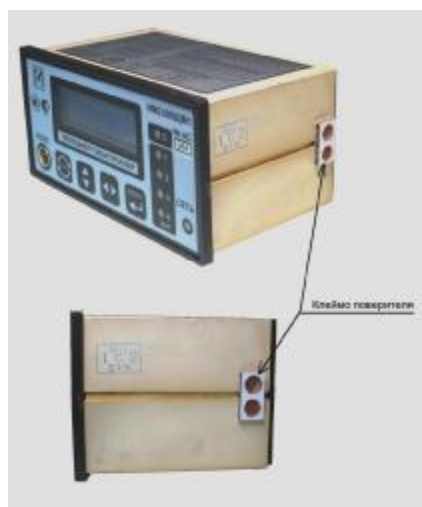
Рисунок 2 – Схема пломбировки комплексов измерительных ИМ2300ГК
