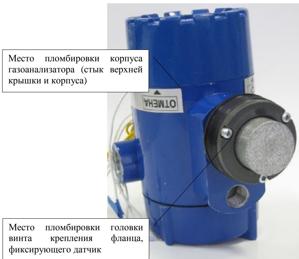
Рисунок 2 - Места размещения пломб
