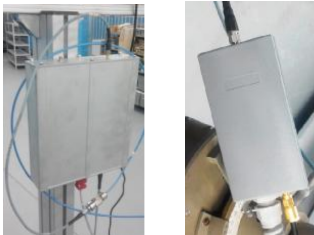
Рисунок 4 – Внешний вид СШП передающего устройства (слева) и выносного смесителя СШП приемного устройства (справа)
