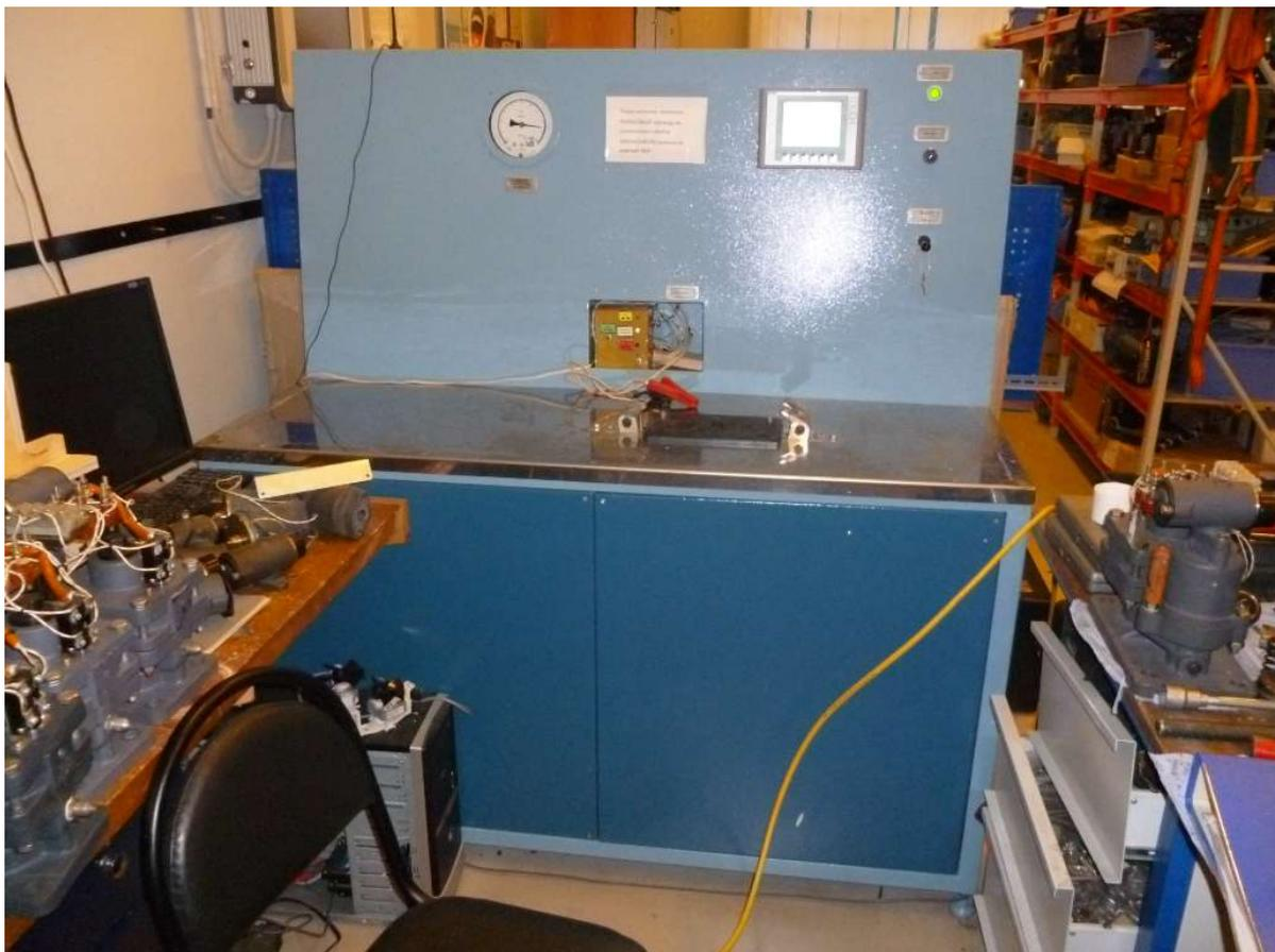
Рисунок 1 - Фотографии общего вида поста контроля электропневматического клапана автостопа (КСК-АвЦ(м) ЭПК)
