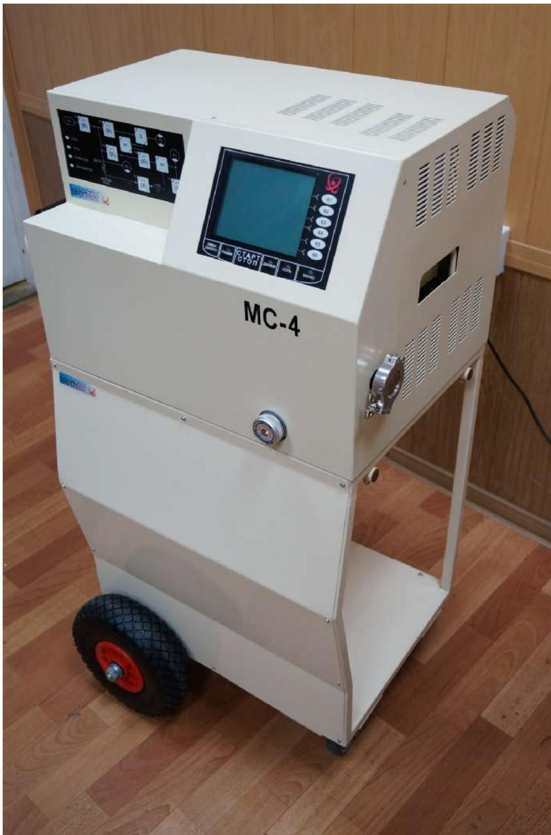
Рисунок 1 – Внешний вид течеискателя
