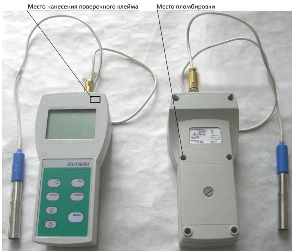
Рисунок 1 – Общий вид кондуктометров, схема пломбировки от несанкционированного доступа и место нанесения знака поверки
