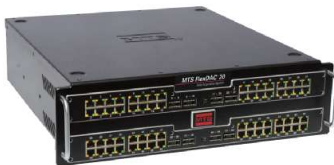
Рисунок 1 – Фотография общего вида автономного блока системы сбора данных MTS FlexDAC 20
