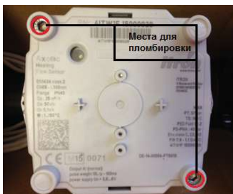
Рис.4– Места пломбирования расходомера Axonic
