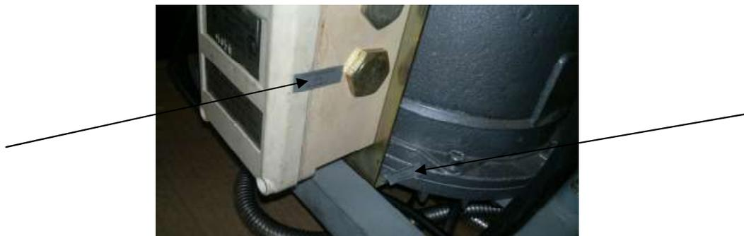
Рисунок 2 - Схема пломбирования
