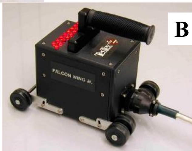
Рисунок1. – Общий вид дефектоскопов FalconWing
