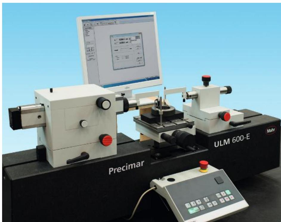
Рисунок 1 – Общий вид приборов универсальных для измерений длины Precimar серии ULM-E модификации Precimar ULM 600-E
