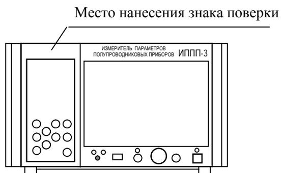
Рисунок 3 – Место нанесения знака поверки (лицевая панель прибора)
