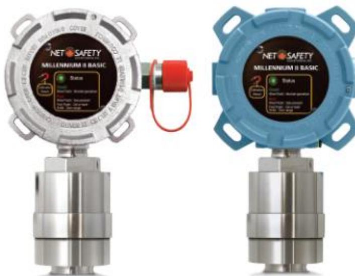
Рисунок 3 – Датчик исполнения M2B-b-c (слева корпус из нержавеющей стали с HART-портом, справа - алюминий)
