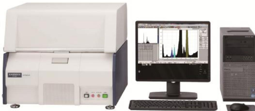
Рис.1 Анализатор рентгенофлуоресцентный энергодисперсионный «EA1200VX»
