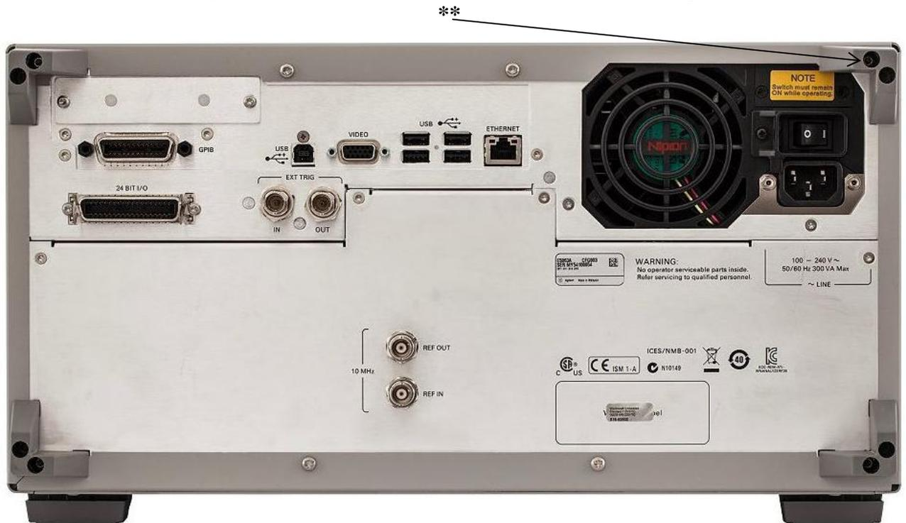
\*\*\* - Место пломбировки от несанкционированного доступа
